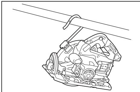
Fije el gancho con los tornillos tal como se muestra en la ilustración.
