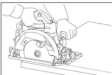
Sujete firmemente la herramienta. La herramienta está provista de empuñadura delantera y mango trasero. Utilice ambos para sujetar de forma óptima la herramienta. Si ambas manos están sujetando la sierra, éstas no podrán ser cortadas por el disco de la sierra circular. Coloque la base sobre la pieza de trabajo a cortar sin que el disco de la sierra circular haga contacto alguno. Luego encienda la herramienta y espere
