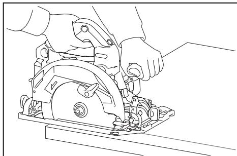
Tenez l'outil fermement. L'outil est équipé d'une poignée avant et d'une poignée arrière. Utilisez les deux poignées pour assurer la meilleure prise possible sur l'outil. En tenant la scie avec vos deux mains, vous mettez celles-ci à l'abri de la lame de scie circulaire. Posez la base sur la pièce à couper, sans que la lame de scie circulaire n'entre en contact avec quoi que ce soit. Allumez ensuite l'outil et attendez que la lame de scie circulaire atteigne sa pleine vitesse. Faites alors
