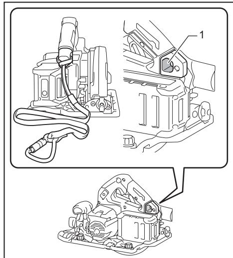
► 1. Orificio para el cordel (correa de atadura)
