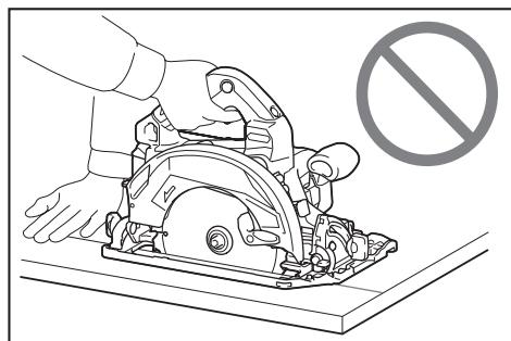
9. **Ne forcez jamais la scie. Poussez la scie vers l'avant à une vitesse permettant à la lame de couper sans ralentir.** Le fait de forcer la scie peut causer une coupe inégale, une perte de précision ou un recul.
