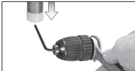
Sujetar el husillo de taladrar con una llave de boca. Aflojar y desatornillar el portabrocas aplicando un ligero golpe con un martillo de goma en una llave hexagonal tensada.
