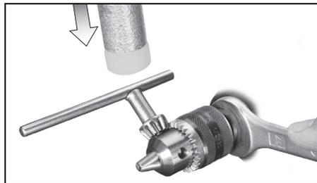
Sujetar el husillo de taladrar con una llave de boca. Aflojar y desatornillar el portabrocas aplicando un ligero golpe con un martillo de goma en una llave para portabrocas insertada.
