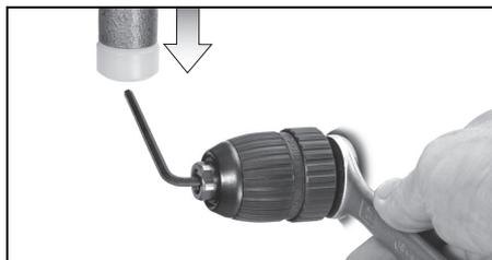
Segurar a árvore porta-brocas com uma chave de boca. Soltar a bucha, batendo ligeiramente com um martelo de borracha sobre uma chave sextavada aplicada e desparafusar.
