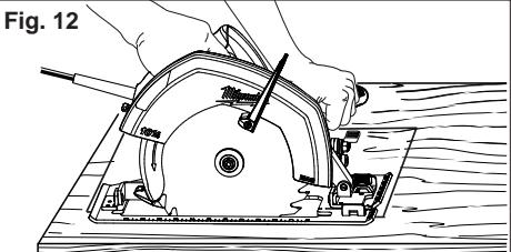
**ADVERTENCIA** El polvo, las rebabas y el grano pueden hacer que la guarda deje de funcionar en cualquier momento. Si se usa la sierra para cortar mampostería o metales, resérvela y márquela para ese uso únicamente, y llévela a un centro de servicio MILWAUKEE para su limpieza y prueba antes de usarla para cortes de madera.
